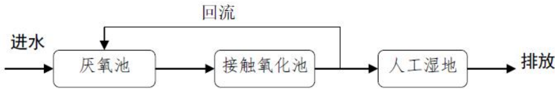
图 5.4-6 厌氧池—生物接触氧化—人工湿地工艺流程图
